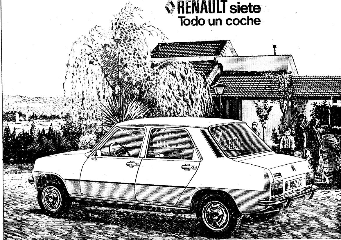
Motor Renault 1.037 cm³ Tracción delantera. Suspensión por barras de torsión. Cuatro puertas.
